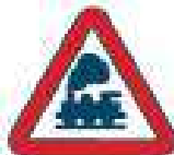
Paso a nivel sin barreras
